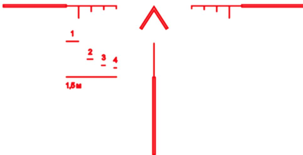
Модель оборудована сеткой LS400 со стрелкой по центру, позволяющей определить расстояние до цели, высотой в 1,5 метра. Максимальная дистанция определения - 400 м.
